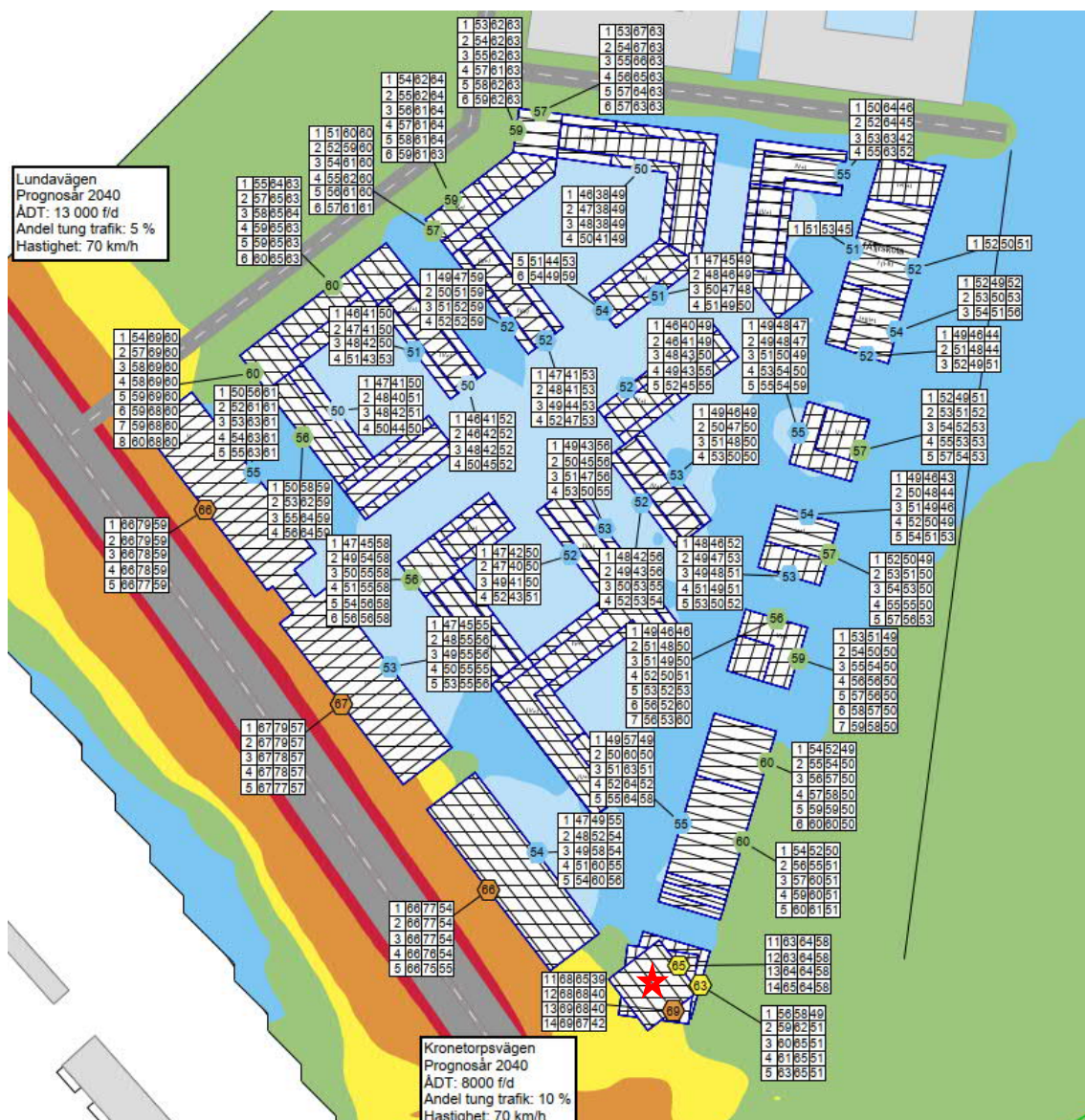
Figur 2. Utklipp från AK01 som illustrerar ekvivalenta nivåer två meter över mark inkl. reflex i egen fasad och fasadnivåer som frifältsvärden på fastigheten Kronetorp 1:1. Grön och blå färg i utbredningskartorna anger ljudnivåer under 60 dBA. 1 kolumnerna för fasadnivåer anger hur Leq (dBA) (2: a kolumnen)/ L_{max} järnväg (dBA) (3:e kolumnen) / L_{max} väg (4:e kolumnen) fördelas per fasad och våningsplan (1:a kolumnen) för prognosår 2040.
