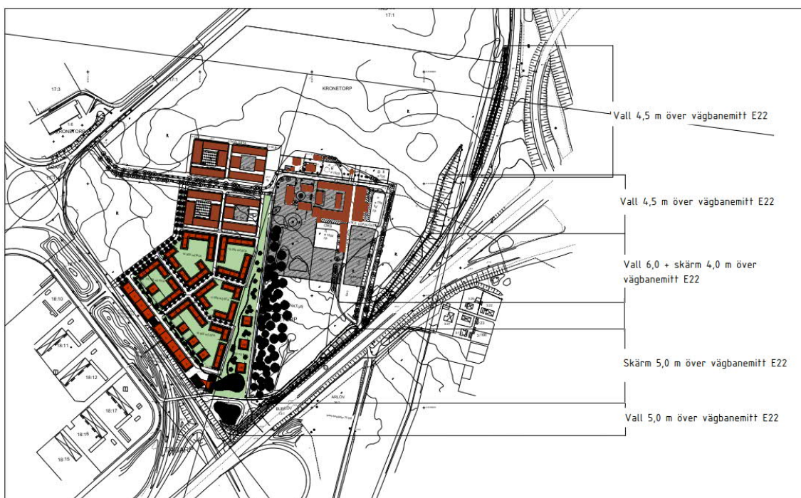
Figur 1. Kartan visar skärm- och vallhöjder i anslutning till planområdet Kronetorp 1:1. Observera att bilden bara avser placering och höjder av vall/skärm. Byggnadsplaceringen är inte aktuell. Skärm och vall måste löpa utan släpp hela vägen.
