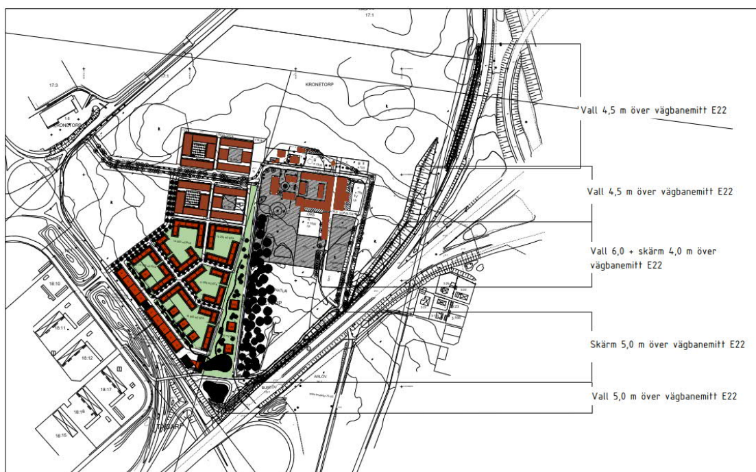
Figur 1. Kartan visar skärm- och vallhöjder i anslutning till planområdet Kronetorp 1:1. Skärm och vall måste löpa utan släpp hela vägen.
