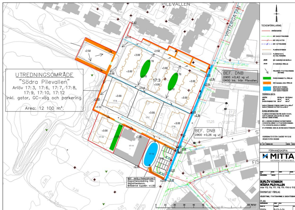
Figur 12. Föreslagen dagvattenhantering i Mitta AB: S dagvattenutredning, se Bilaga 2 (2019-11).
