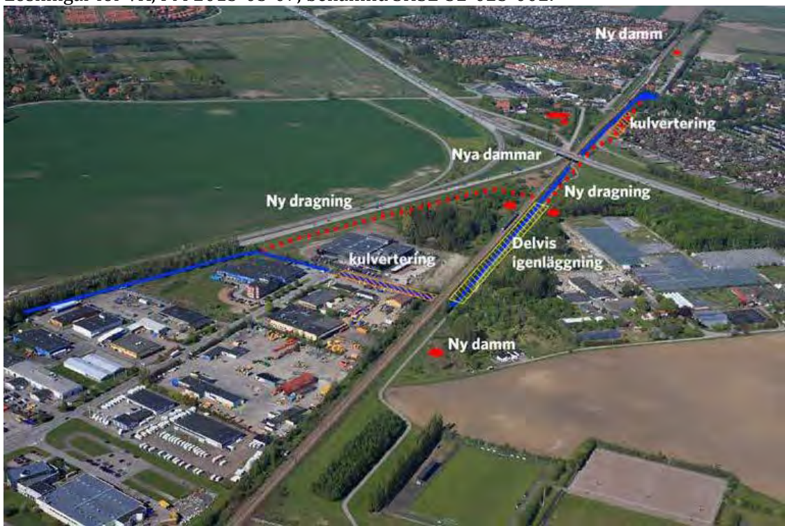
Förslag till åtgärder avseende Alnarpsån samt föreslagen placering av fördröjningsdammar. Fotograf Perry Nordeng.
