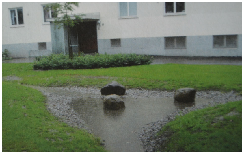
Bild 4. Exempel trög avledning med öppna avvattningstråk/mindre damm där dagvattenavledning sker mot vänster i bild. Under största delen av tiden kan ytorna användas för rekreation med mera i väntan på skyfallen, så kallade mångfunktionella ytor.
