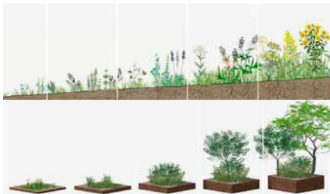
Det finns ett tydligt samband mellan substratdjup och vegetation. Överst: tunna växtbäddar. Nederst: tjockare växtbäddar. (Gröna Takhandboken, 2a utgåvan)
